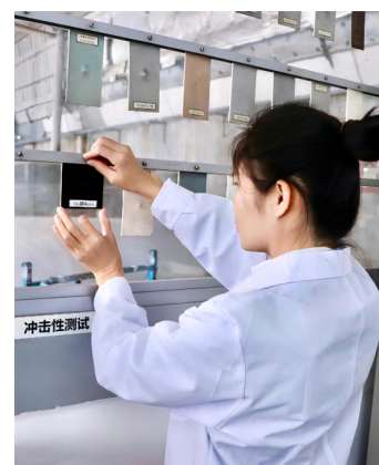
漆膜耐冲击测试后观察漆膜变化
